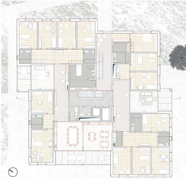
«dreiklang», Grundriss 1.–4. Obergeschoss, Mst. 1:125. Die Anordnung der Räume erinnert an das Siegerprojekt, unterscheidet sich aber in den deutlich ausgeprägteren Erschliessungszonen und der dezentralen Platzierung der Betriebsflächen.
