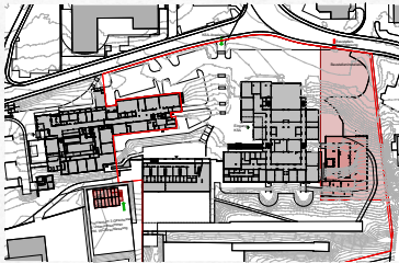
1.1 1. Etappe 1. Bauphase Neubau Mensa
