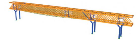
Abbildung zeigt die maximale Durchbiegung der Konstruktion in Folge des Lastmodells.
