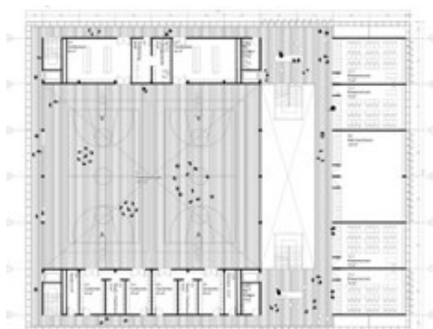
2. Obergeschoss, Doppelturnhalle und Klassenzimmer 1:800
