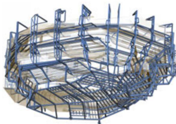
**Der grosse Konzertsaal** besteht aus einem Box-in-Box-System, bestehend aus zwei unabhängigen Schalen (Bild oben). Die **Stahlkonstruktion der Innenschale** (grün und Bild darunter) sitzt über 342 Federpakete akustisch entkoppelt auf den Betonrippen der Aussenschale (rot).
