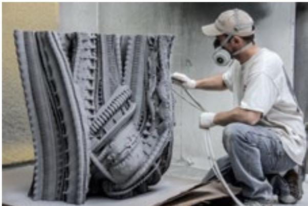
Die Produktion von «Digital Grottesque»: Vor allem **komplexe Bauteile** können mit 3-D-Druck um ein Vielfaches schneller als mit herkömmlichen Verfahren produziert werden.
