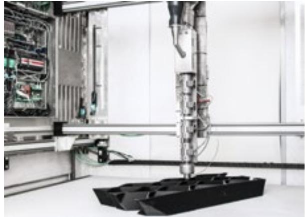
Die Fertigteile des Kanalhauses werden in **Konstruktions-Schmelzklebstoff** gedruckt. Dieser besteht zu 80% aus Pflanzenöl und verflüssigt sich bei 170 °C. Grundsätzlich kann jedes Material eingesetzt werden, das nach dem Schmelzen wieder aushärtet.
