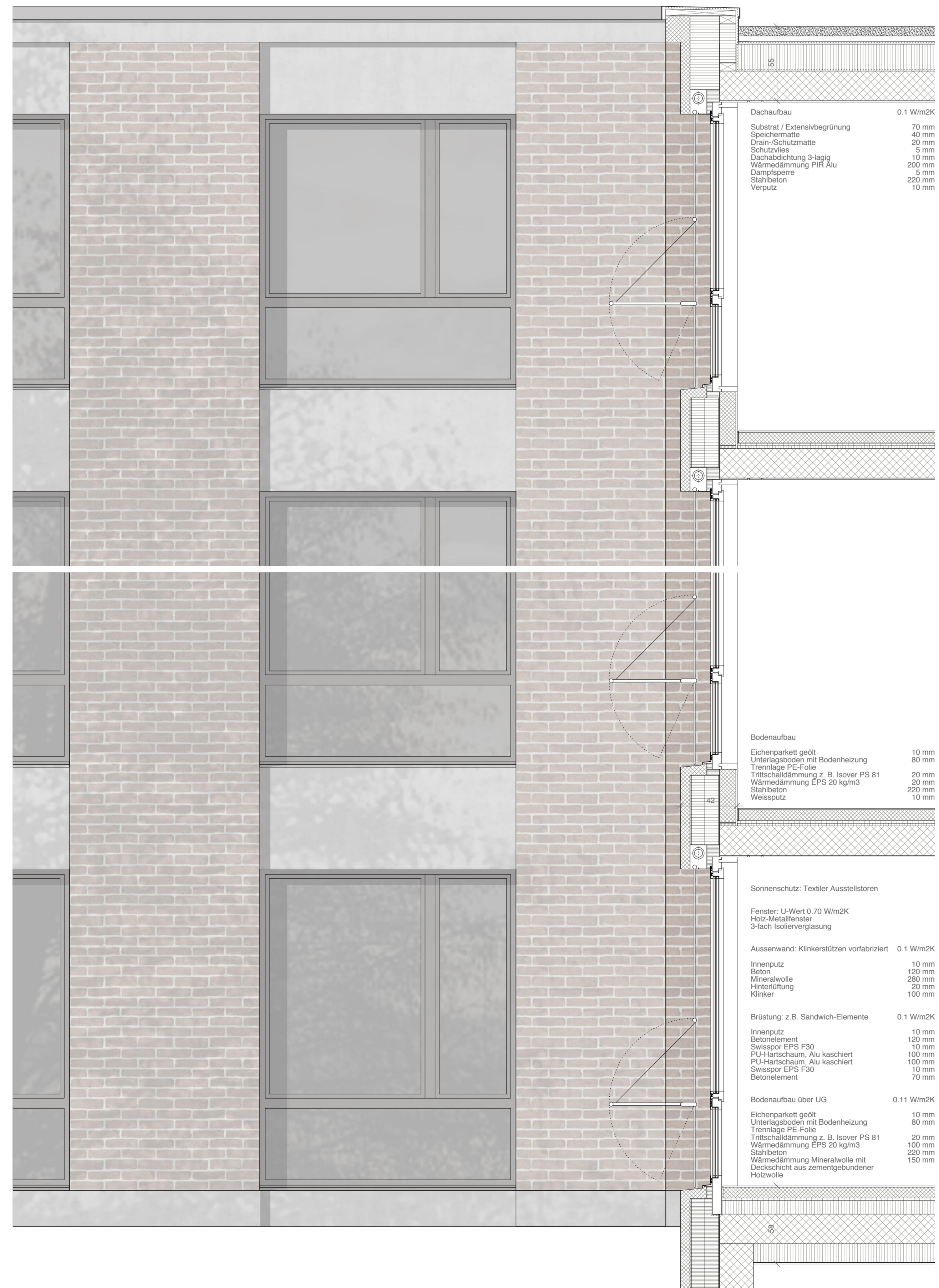
Detail Ansicht / Schnitt Neubau 1:20
