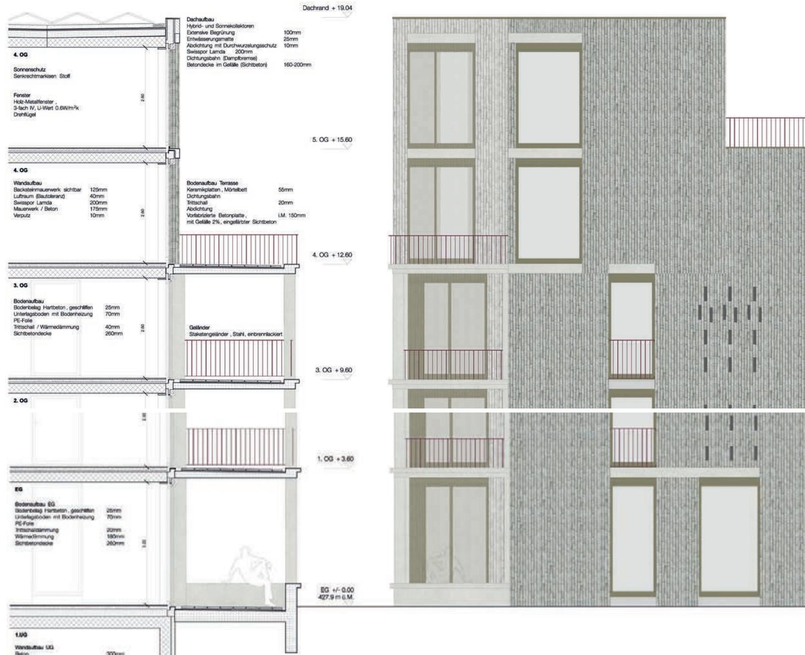
Detailschnitt Fassade 1:100
