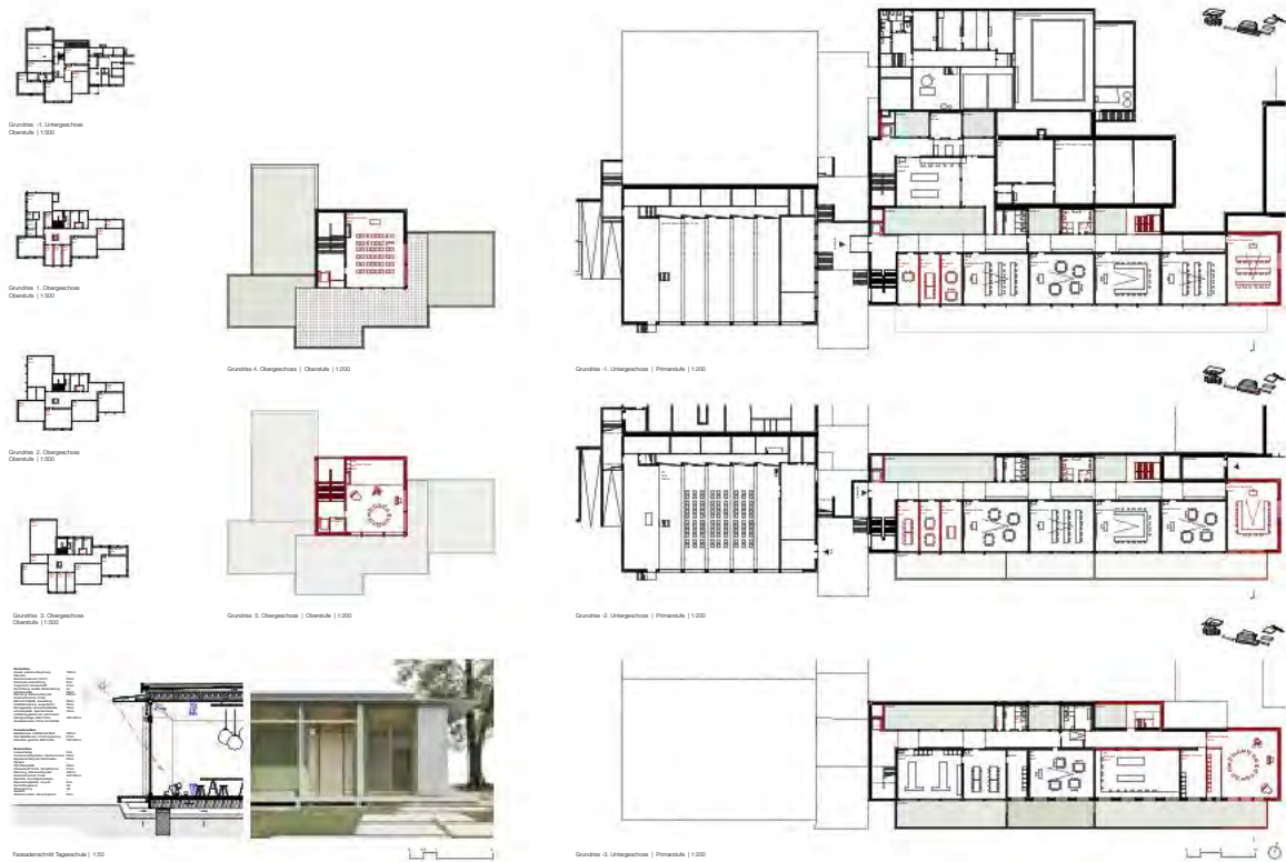
Abb. 5: Grundrisse und Detailschnitt Neubau
