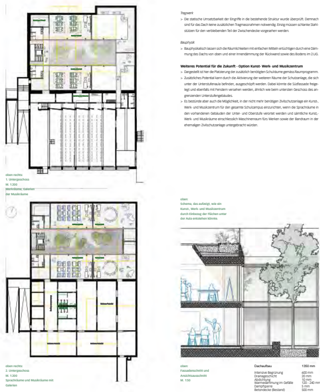
Abb. 23: Grundriss Zivilschutzanlage mit Detailschnitt
