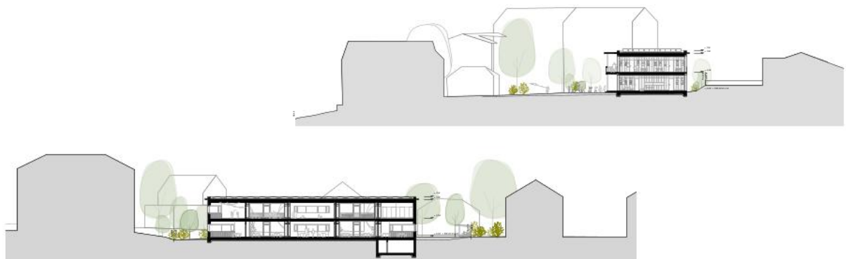
Abb. 45: Quer- und Längsschnitt Neubau
