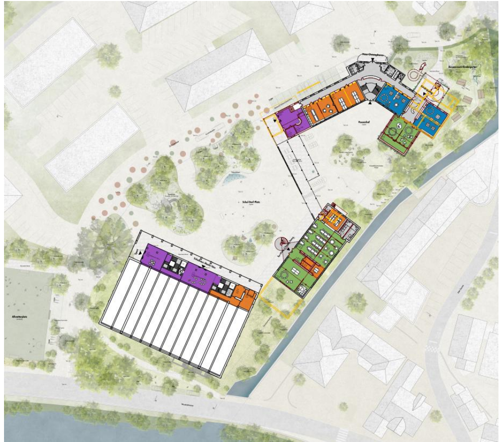
Abb. 3 Situation mit Erdgeschossgrundriss
