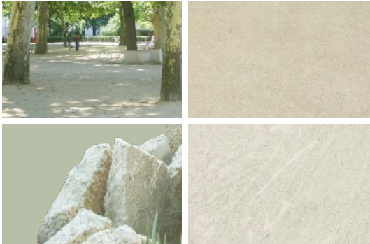
Farblich abgestimmte Platzfläche (Stabilizer) und Bruch (Betonplatten)
