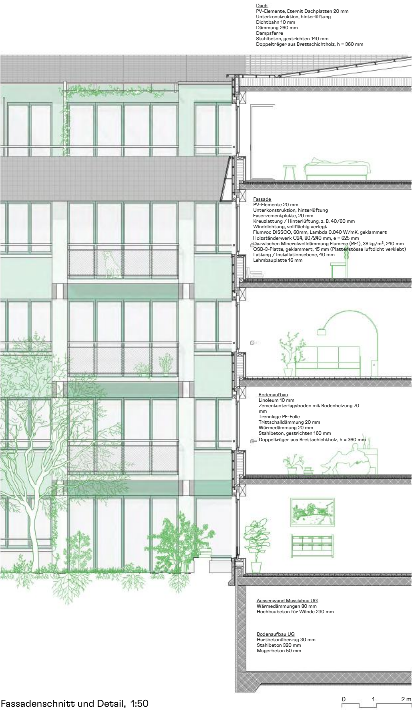
Fassadenschnitt und Detail, 1:50
