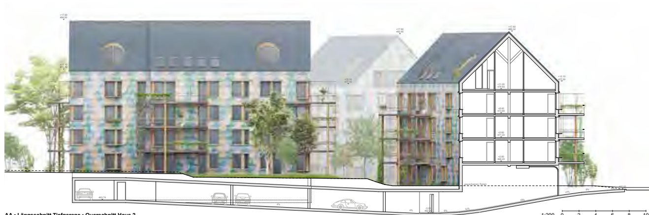
AA • Längsschnitt Tiefgarage • Querschnitt Haus 2
