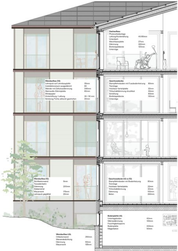
Konstruktionsschnitt und Ansicht - Wohnen - 1/50
