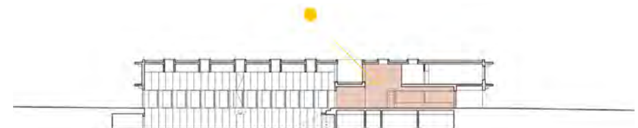
Principe de gestion de la lumière - Bâtiment Soleil
