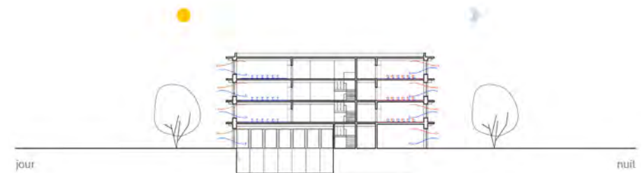
Principe de ventilation - Extension de Jupiter
