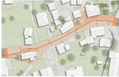
Schema Ausrichtung Natursteinpflaster Granit - Natursteinpflaster Ausrichtung längs zur Strasse, u.a. breites Natursteinband - Natursteinpflaster Ausrichtung parallel zum alten Schulhaus und zur Kapelle - Natursteinpflaster Ausrichtung quer zur Strasse
