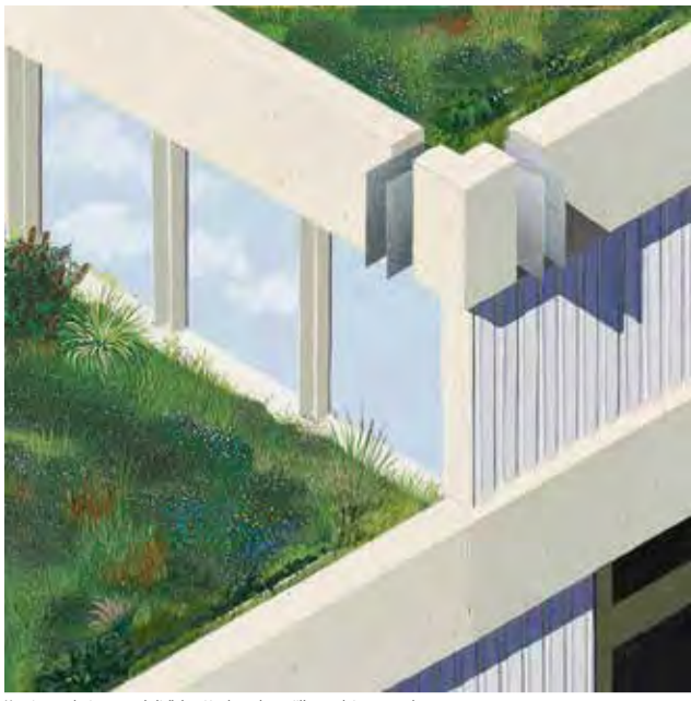
L'eau traverse les terrasses végétalisées et tombe par les gouttières sur la terrasse en dessous
