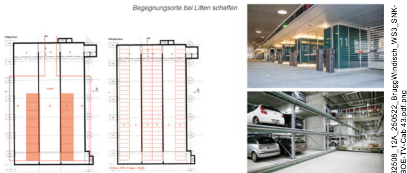
Abb. 42 Parkierung im unterirdischen Rollenlager; Team «Salewski Nater Kretz»
