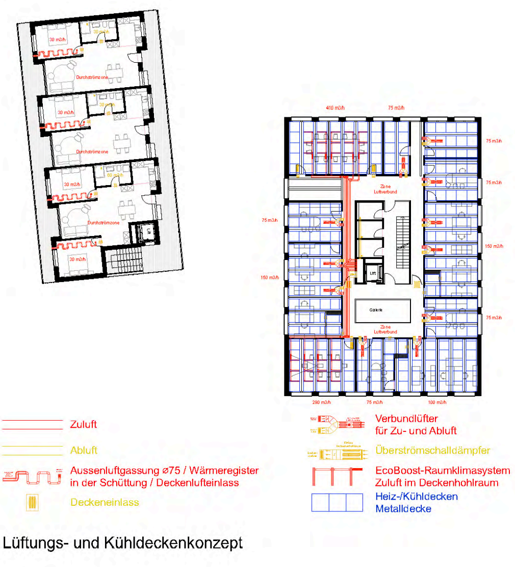
Lüftungs- und Kühldeckenkonzept
