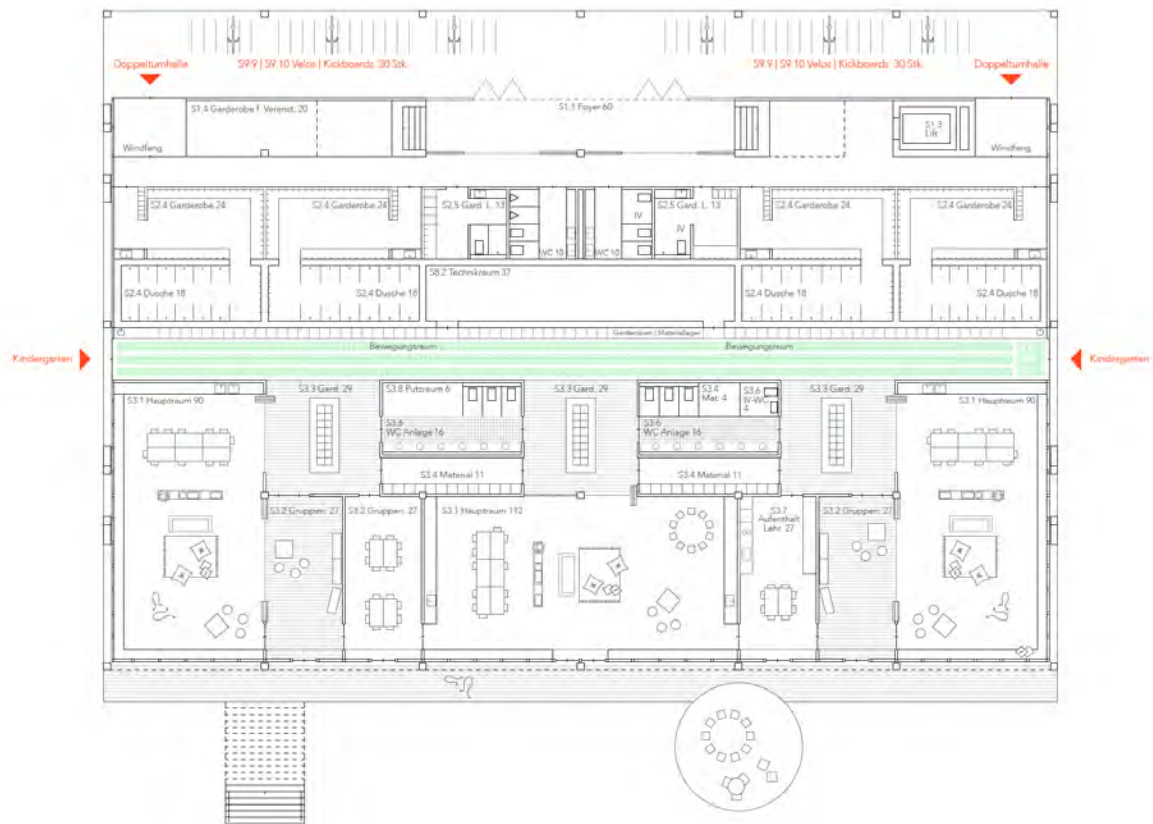
Erdgeschoss Kindergarten / Turnhalle Perimeter Süd
