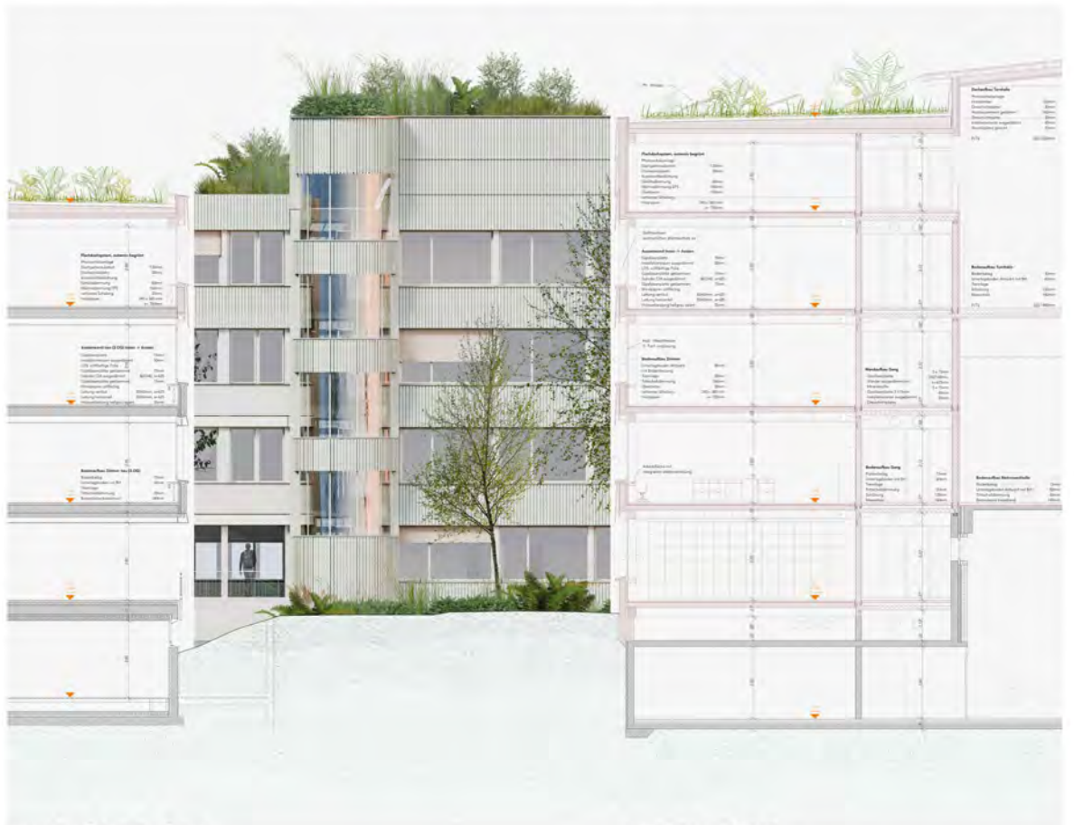
FASSADENSCHNITT BESTAND + AUFSTOCKUNG, NHT, 1:30
