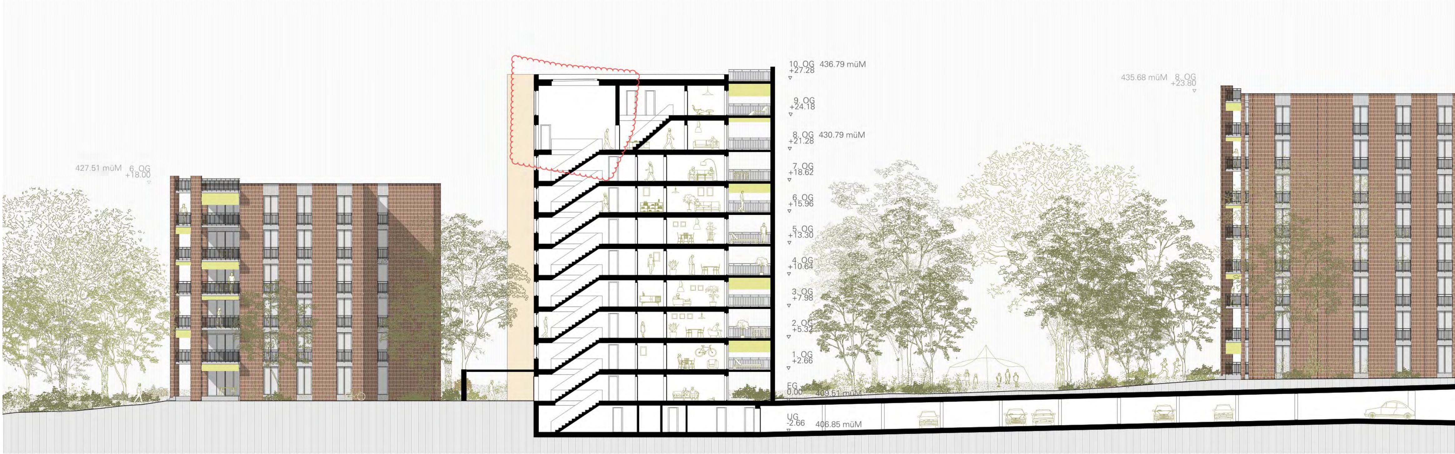
Schnitt durch das bestehende Gebäude 1:200
