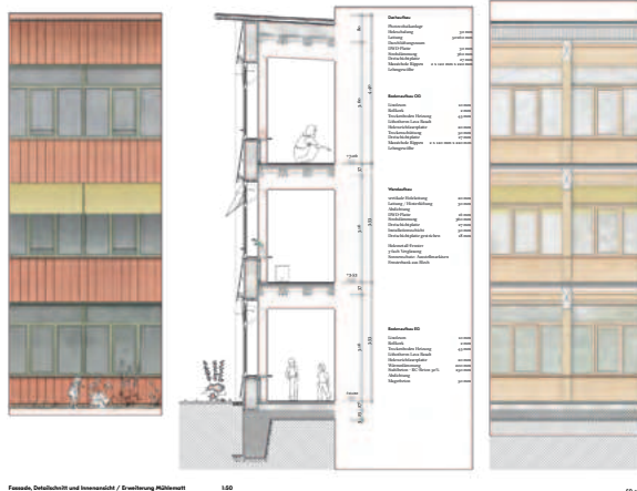
Fassade, Detailschnitt und Innenschnitt / Erweiterung Mühlematt 1:50
