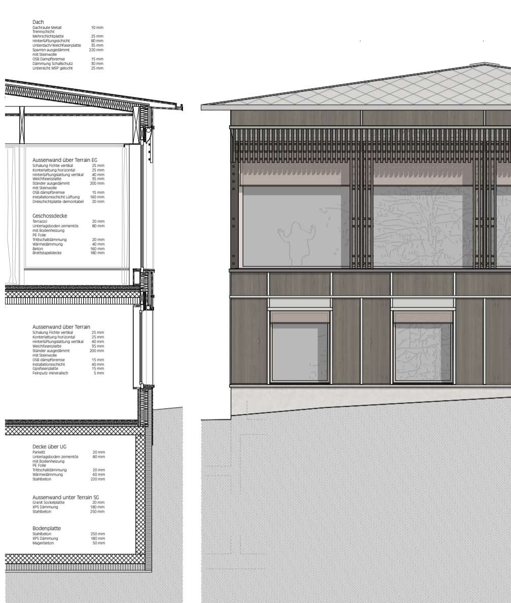
Konstruktionsschnitt & Ansicht Pfarreizentrum 1:50
