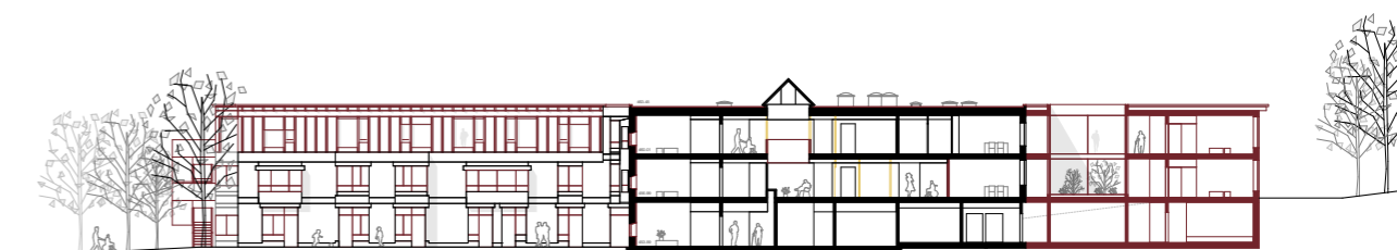
Coupe existant et nouvelle aile | Façade sud-est surélévation 1:200
