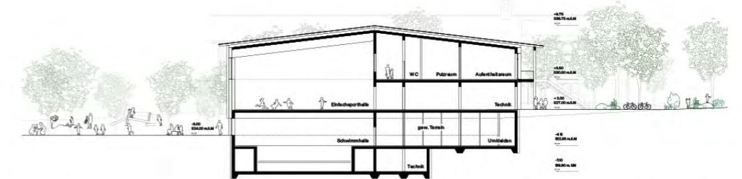
Schnitt Einfachsporthalle und Schwimmhalle
