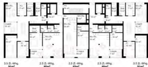
Baufeld B Regelfgeschoss 4.-15.OG
