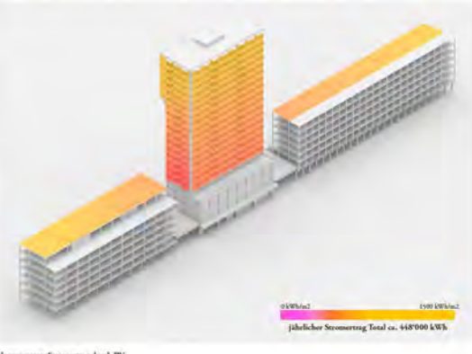
Solargenerierte Stromerzeugung durch PV
