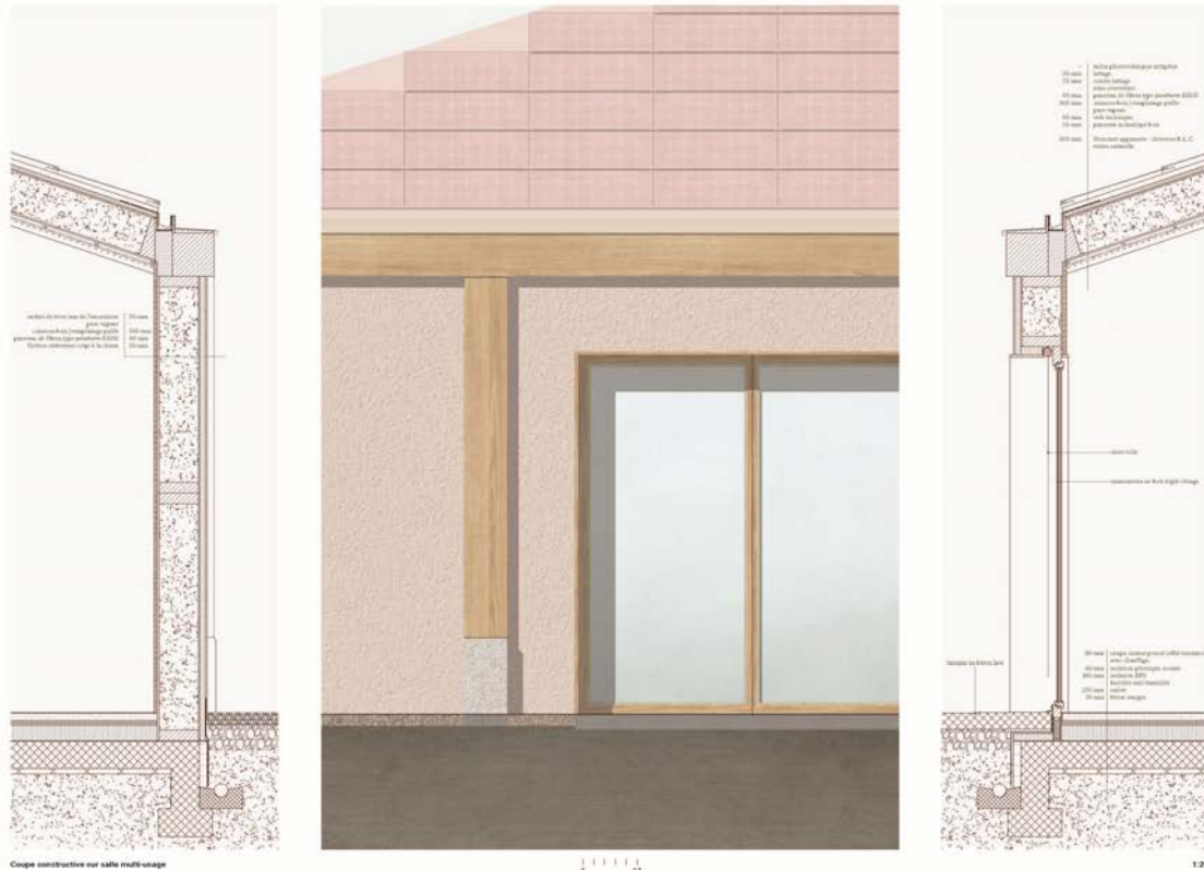
Coupe constructive sur saite multi-usage
