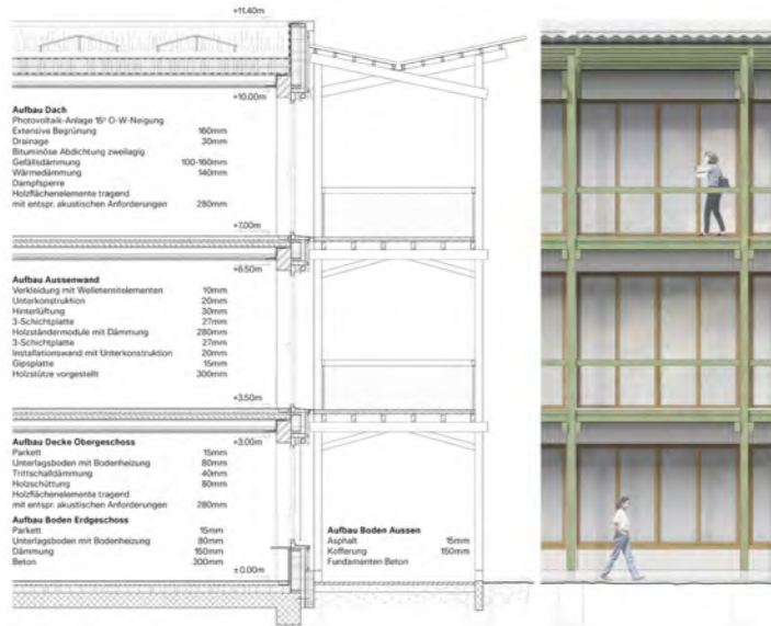
Fassadenschnitt Längsbau | 1:50
