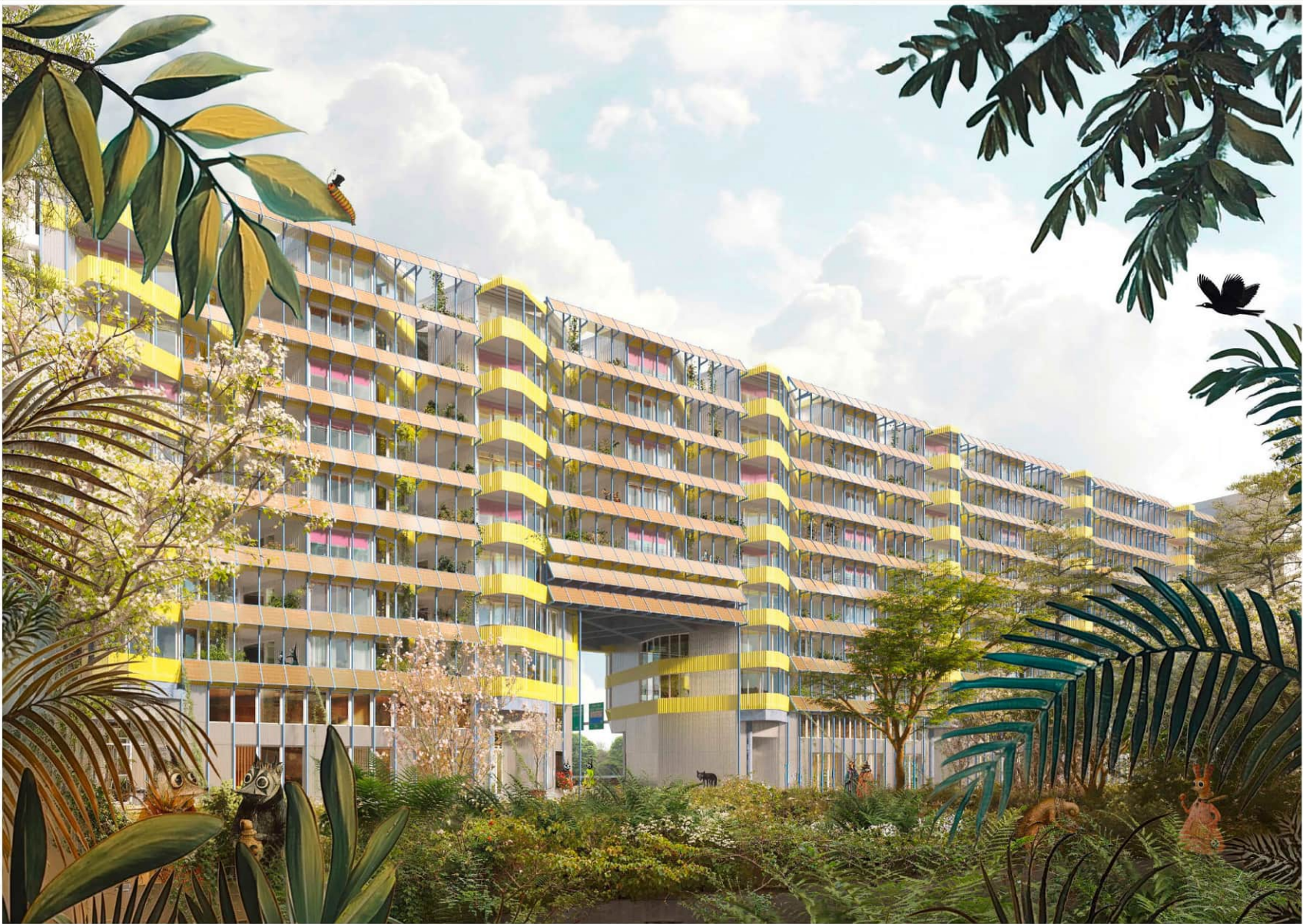
Die dem Wind zugewandte Seite ist mit vertikalen Gartenhöfen zum grossen Hof geöffnet. Die Veranden und Balkone werden mit Brise-Soleils aus PV verschattet und bodengebunden benarkt. Durch die Verkipfung der Fassaden gibt es Ausblick in verschiedene Himmelsrichtungen.
