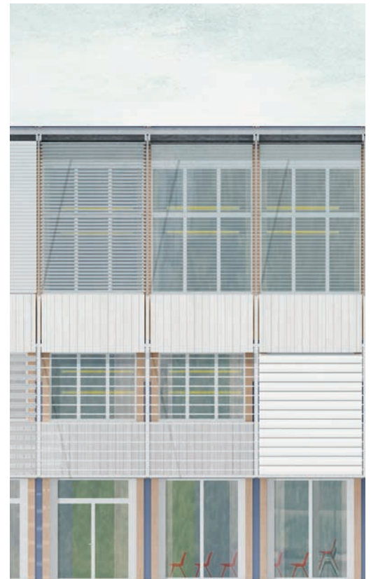
Fassadenansicht Ausschnitt M=1:50
