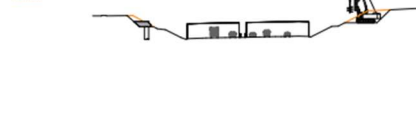
PHASE 2 - Mise en place de la passerelle jusqu'à la travée médiane au nord de la voie d'échange de droite et gauche. - Pose de la passerelle sur le pont suspendu. - Pose de la passerelle sur la travée médiane dans une opération indépendante de celle-ci.
