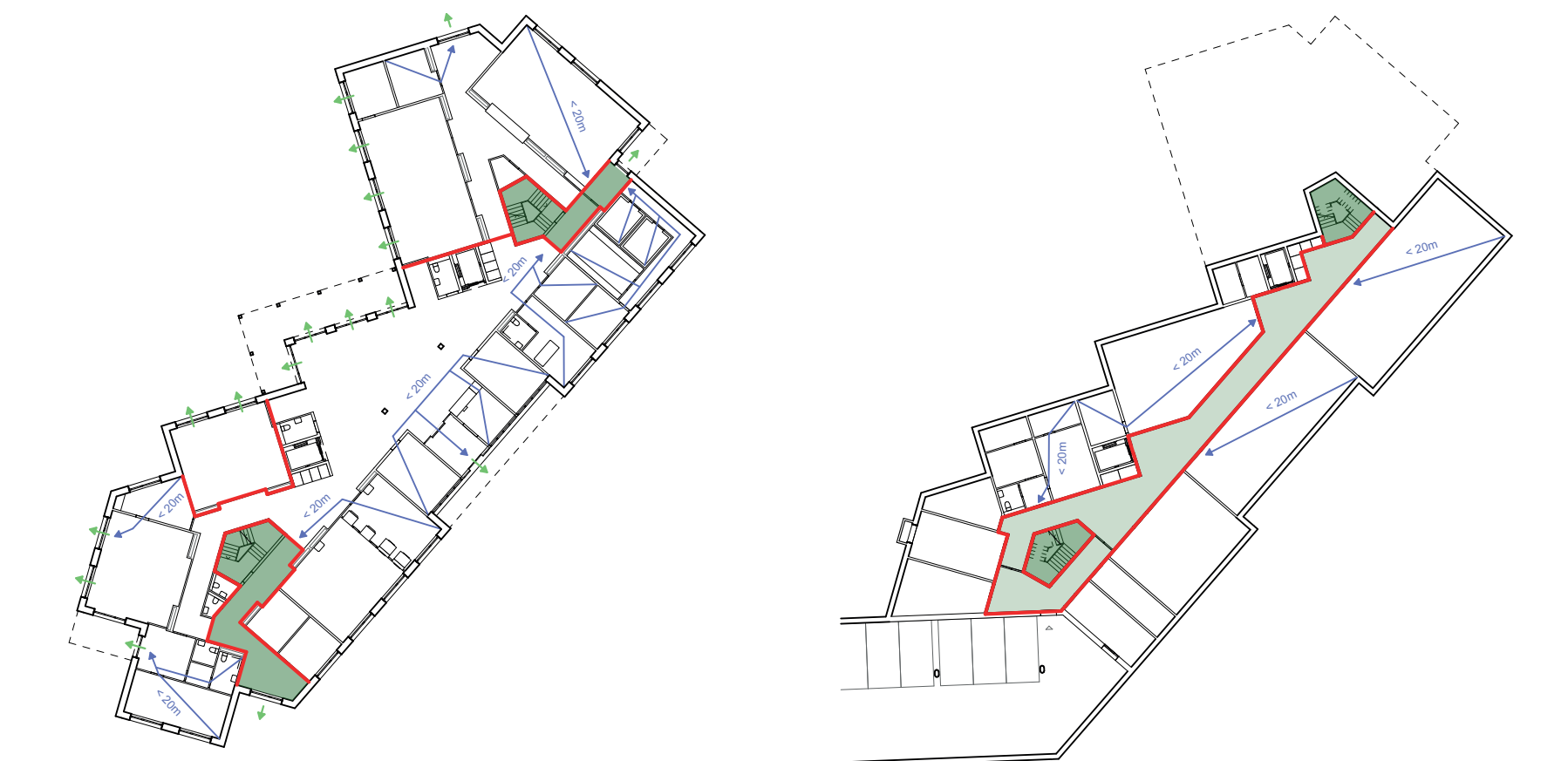
Schéma AEAI EMS : plan rez-de-chaussée 1:500
