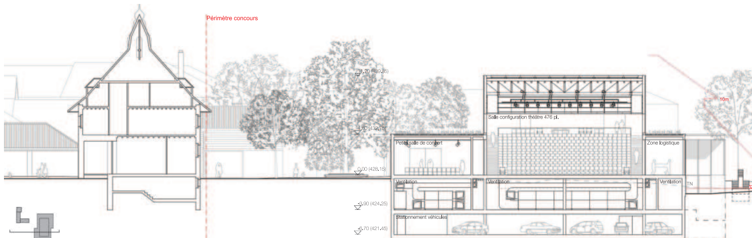
COUPE TRANSVERSALE SUR LA SALLE POLYVALENTE 1 : 200
