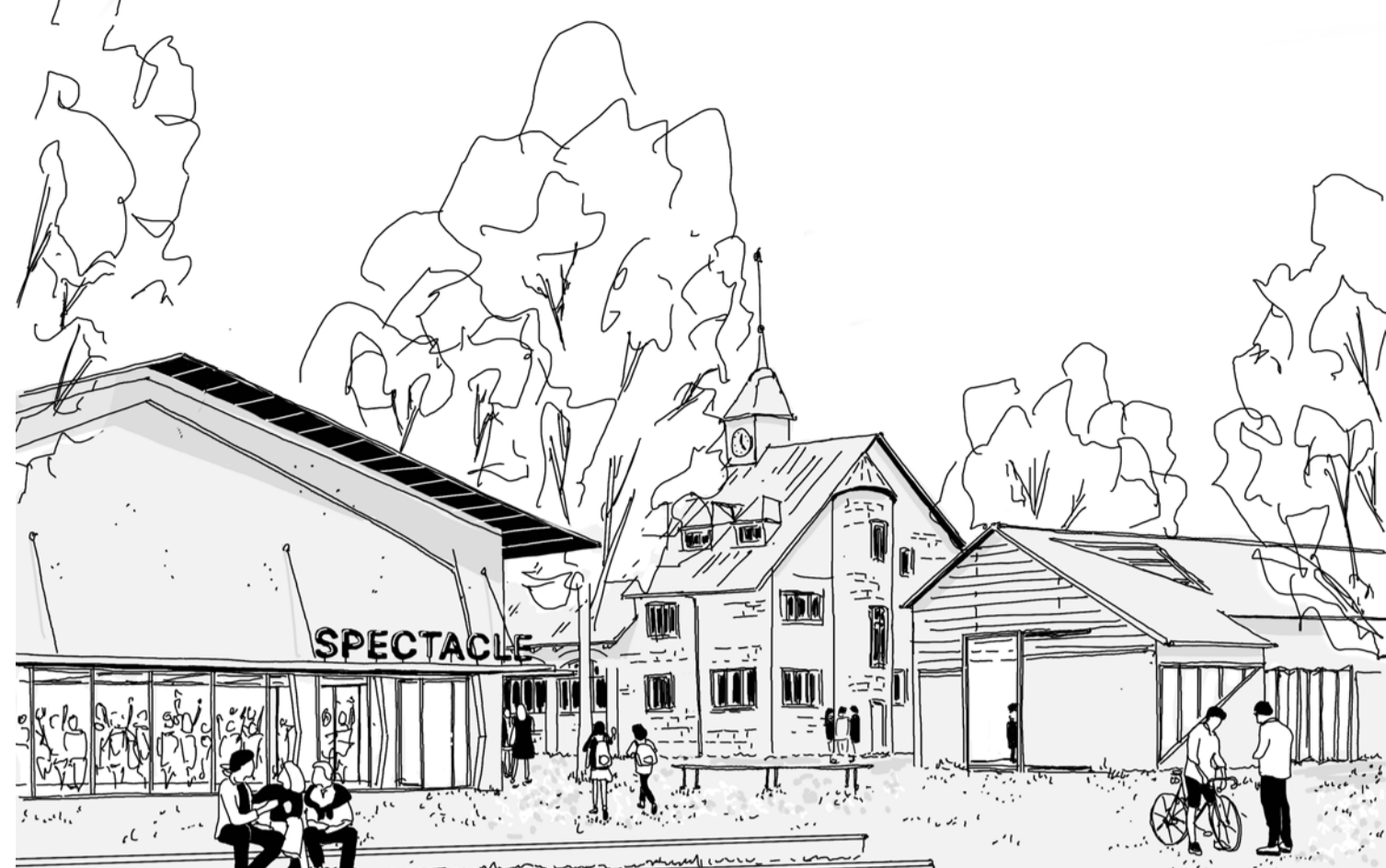
La façade existante face à la Route de Chancy est entièrement transformée, le remplissage existant est supprimé et remplacé par une façade en verre. Un nouvel avant-toit apporte de l'ombrage et une protection au bâtiment et à l'espace public.
