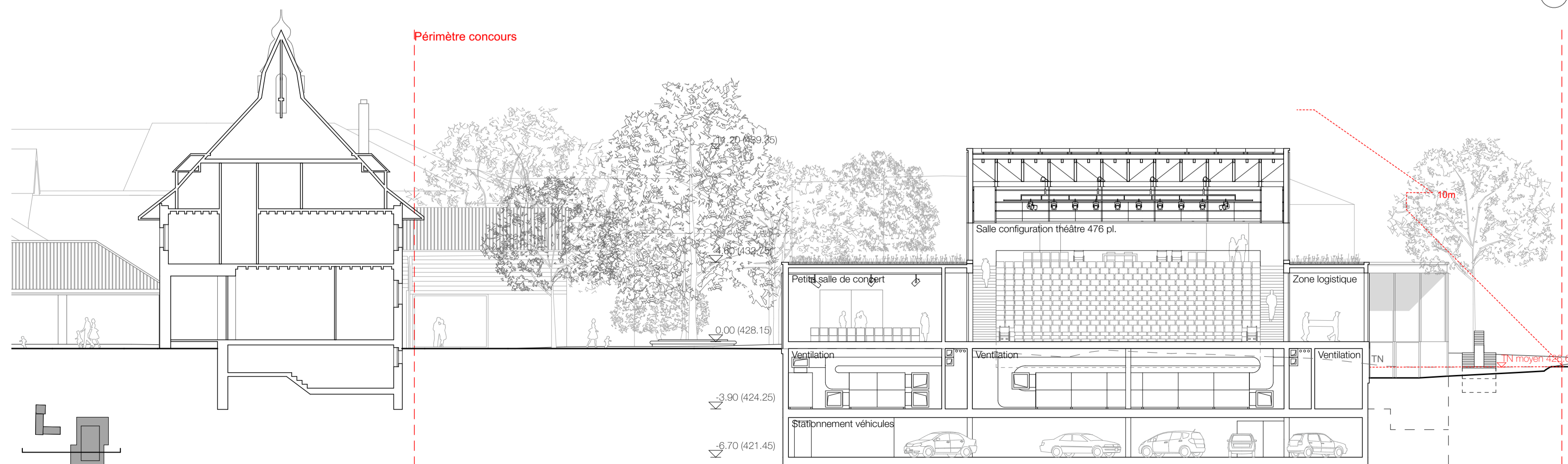
COUPE TRANSVERSALE SUR LA SALLE POLYVALENTE 1 : 200
