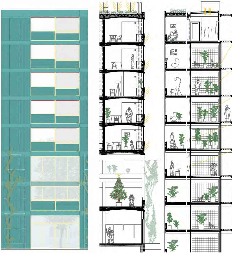
Ausschnitt Fassade und Konstruktionsschnitt 1:200
