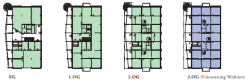
STRASSENHAUS: Büro- und Dienstleistungsfächen (Umnutzung mit 3 Wohnungen 5.5 Zi. /Wlg)
