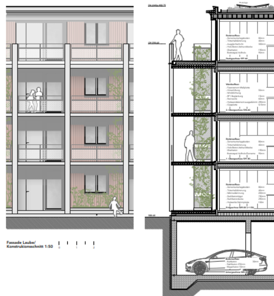
Fassade und Schnitt
