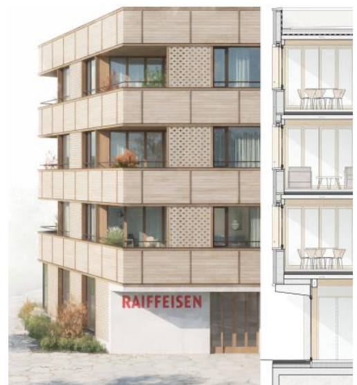
Ansicht und Schnitt Fassade
