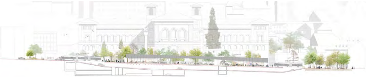
LES NOUVELLES TRÉMIÈS D'ACCÈS AU PARKING SONT PRISES EN CHARGE DEPUIS LA BERMÉ CENTRALE DE LA RUE DU TUNNEL, LIBÉRÉ DE LA VOITURE - COUPE EE', échelle 1.500
