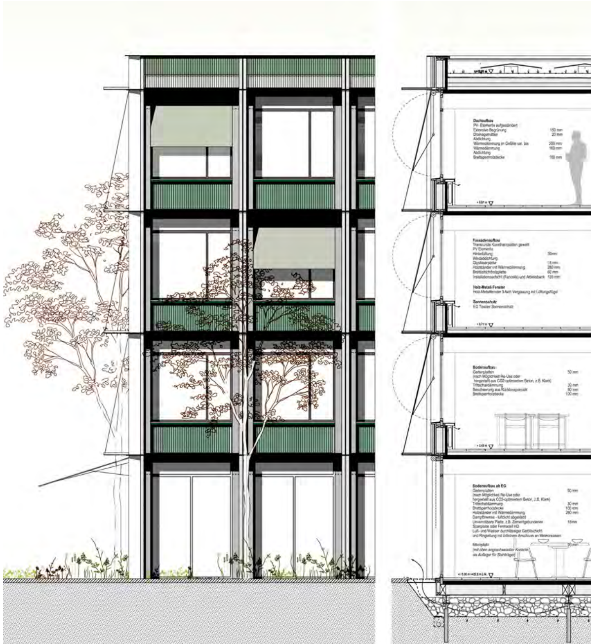
Detailansicht und Konstruktionsschnitt 1:100
