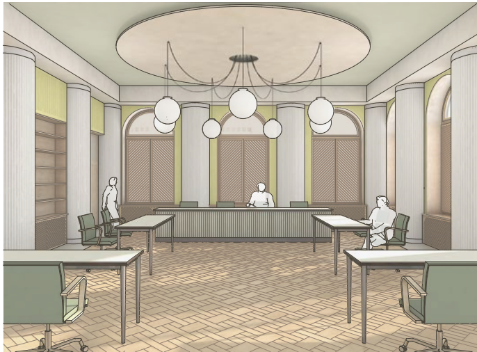
Die grossen Gerichtssäle besetzen den Nord-West Kopf des Gebäudes. Die halbrunden vorgestellten Säulen sind mit Akustik, Leitungen und Dämmung gefüllt und gliedern die Aussenfassaden und die Bibliothek. Der Sichtschutz wird durch die Holzlamellen vor den Fenstern gewährleistet.
