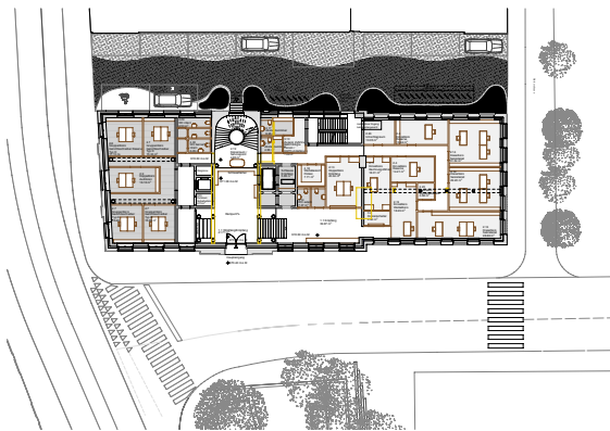
Erstgeschoss 1 : 200 ■ Bestand ■ Neu ■ Abbruch ■ Einbau, Möbel
