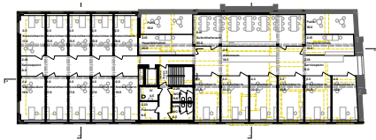
5. Obergeschoss / Bürogeschoss / Aufstockung | 1:200
