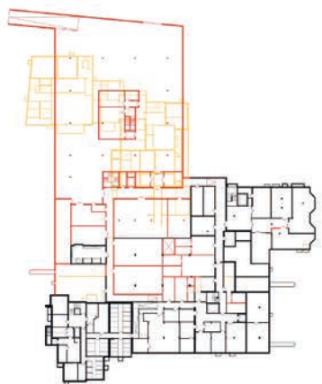
Bestand, Abbruch, Neu - i. Untergeschoss Mit. 1:200
