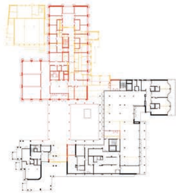
Bestand, Abbruch, Neu - Erdgeschoss Mit. 1:200
