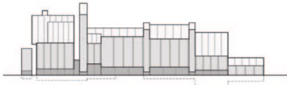
Vertikale Fuge Vom schweren steinigen Sockel bis zum leichten Dachabschluss. Vertikale Fugen gliedern das Gebäude, die obere Ebene ist leicht nach hinten versetzt, der Rhythmus der Vertikalen enger gesetzt.
