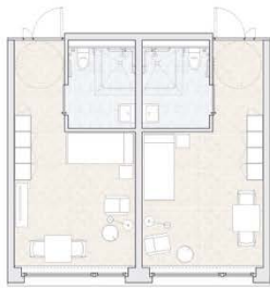
Einzelzimmer Erweiterungsbau Mst 1:500
