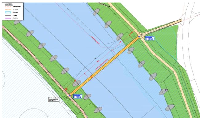
Le profil en long peut être optimisé (légère variation verticale) mais uniquement dans la mesure où l'élançement de l'ouvrage, selon sa conception dans le respect du gabarit du Rhône, le permet.
