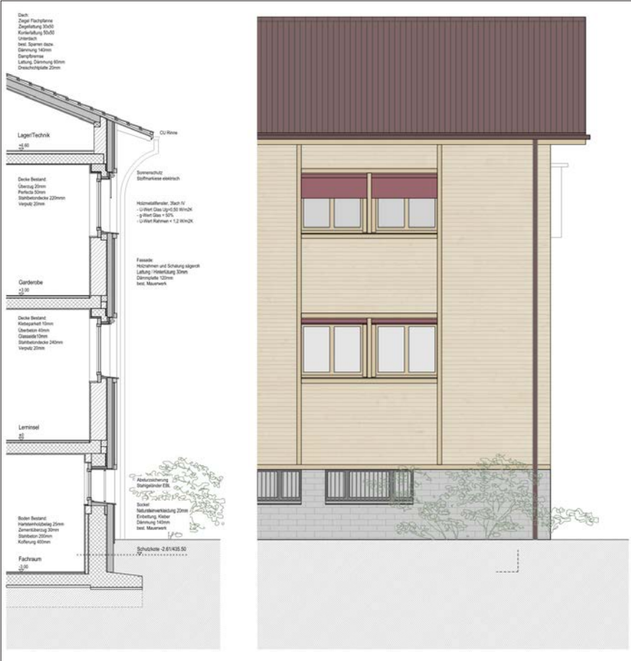
Primarschulhaus Fassadenschnitt und Fassadenansicht
