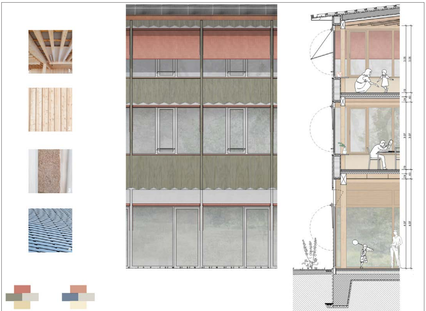
Primarschulhaus Materialisierung, Fassadenschnitt und Fassadenansicht
