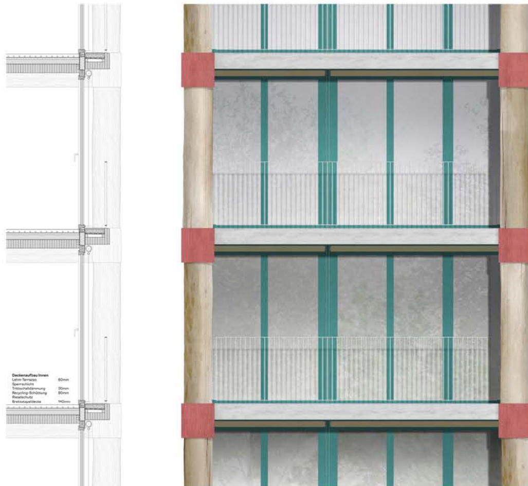
Fassadenschnitt und Ansicht Grand Chalet M1:20
