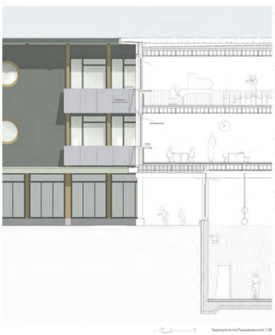
Detailansicht mit Fassadenansicht 1:50
