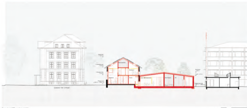
Querschnitt EEB und Auk 1:200
