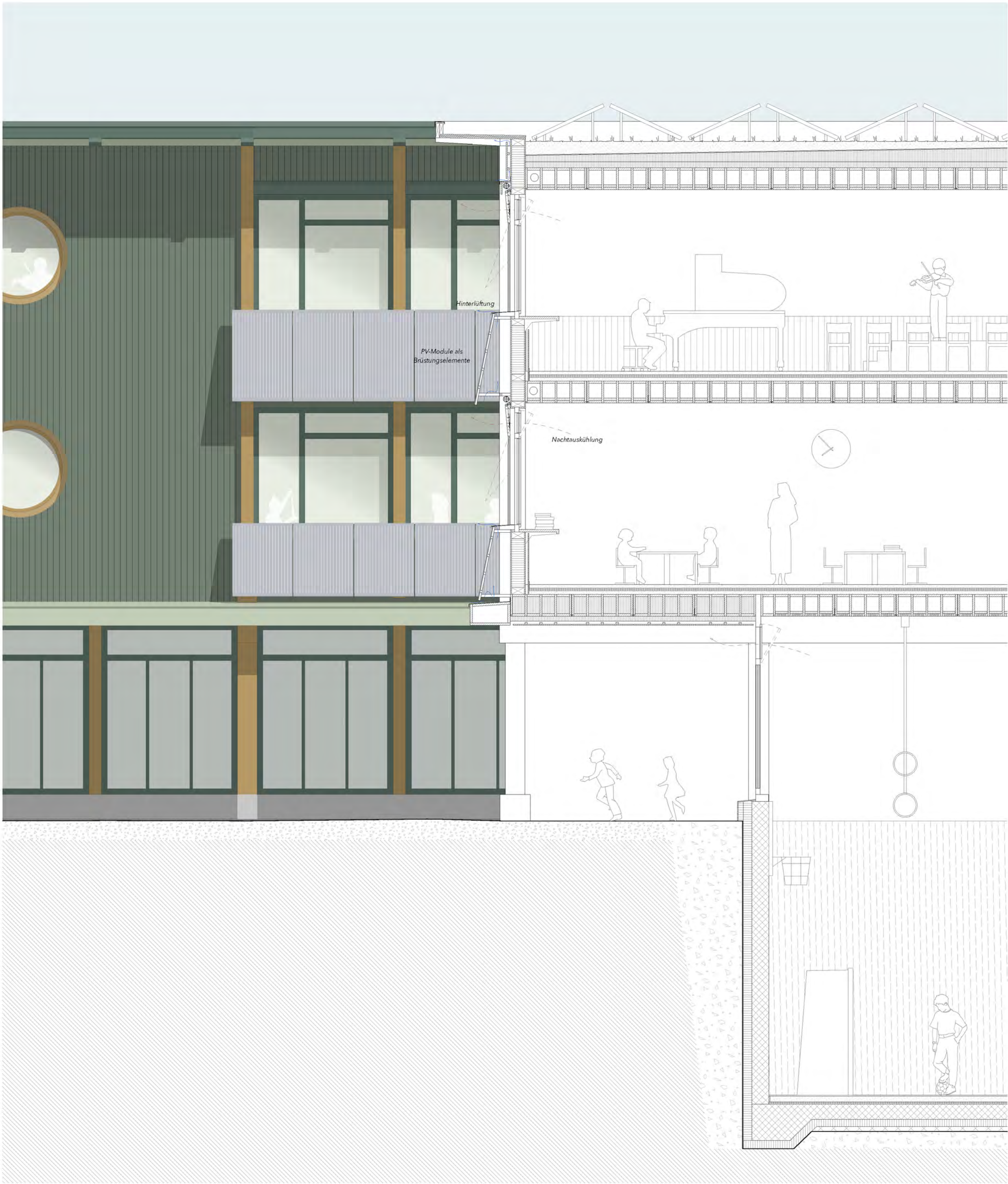
Detailschnitt mit Fassadenansicht 1:50
