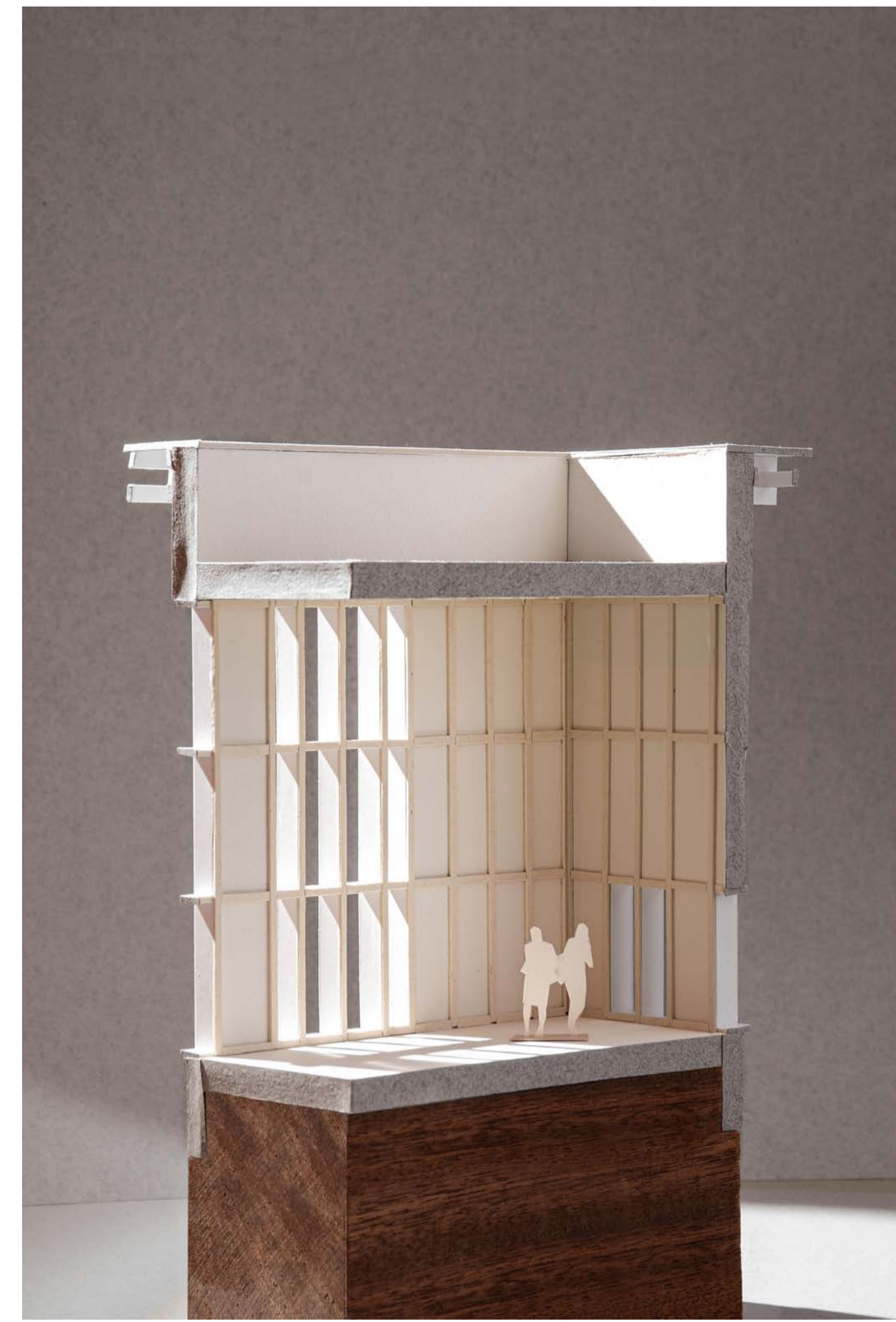
La structure du bâtiment, également en bois, s'exprime à l'intérieur de la nouvelle salle polyvalente. Elle est isolée avec un matériau à très faible empreinte carbone et à masse élevée, contribuant ainsi à la barrière acoustique extérieure et à l'inertie thermique du bâtiment.
